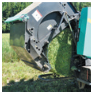
刈り取った稲はコンバインの中で300kgにロールされ出できます
