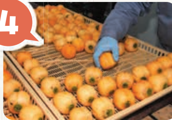
皮をむかれた西条柿はエビラと呼ばれる専用のパレットに並べ、乾燥機に入れられます。
